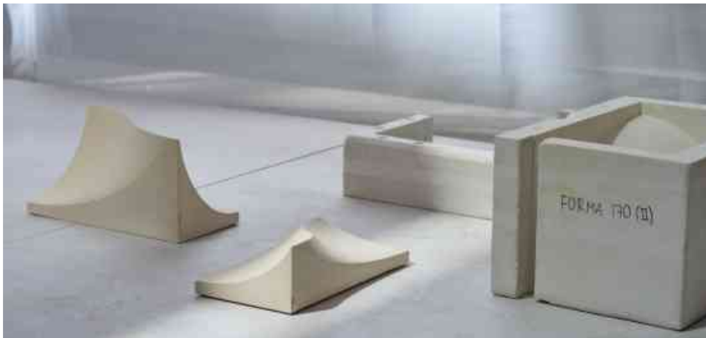
Ryc. 13. Sztuczkowe formy negatywowe i uzyskane z nich odlewy.
