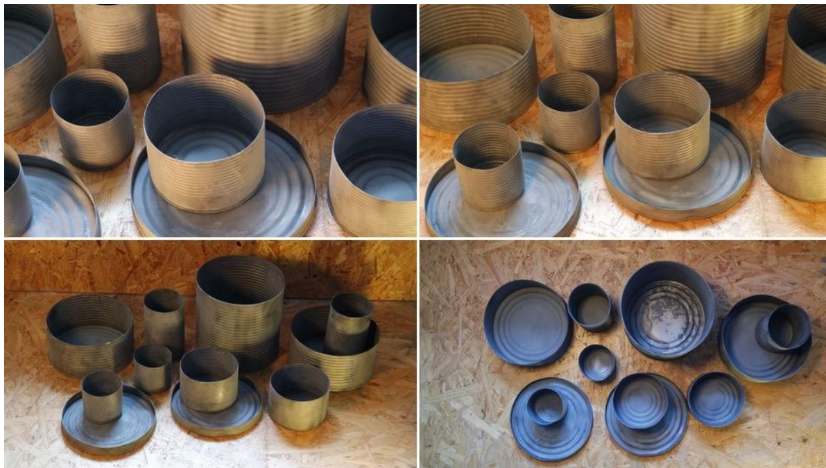
Ryc. 34. Pocięte i oczyszczone puszki stalowe. Przygotowane do nałożenia emalii
